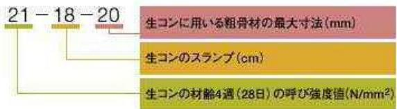
この例のように21-18-20というように表している標準の生コンは、その品種の内容をユーザーに対して誤りがないように正確に示す場合には、下の図-2のような生コンJISによる表示内容ということになる。
